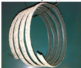
Рис.1 Фрагмент отделившейся шлаковой корки с наплавленной поверхности вала машины непрерывной разливки стали.
